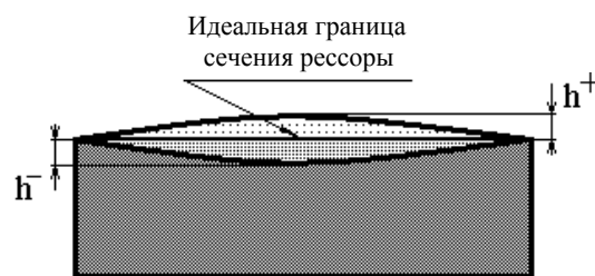
Рис. 5. Макроотклонение формы сечения в виде трапеции, вызываемое бочкообразным профилем прокатного валька
