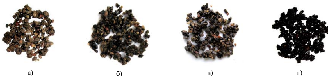
Рис. 1. Образцы битумоминеральной смеси после кипячения: а – БО; б – БК; в – БС; г – БКГ
