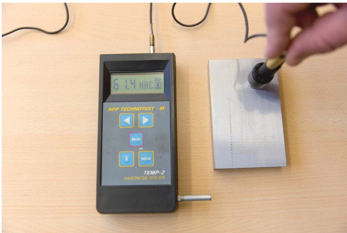
Рисунок 2 – Индицируемые символы на дисплее при включении прибора кнопкой “MOD”
