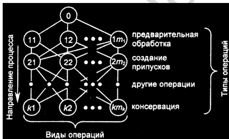
Рис. 3. Граф вариантов технологического процесса восстановления детали: 1, 2, ..., k – типы операций; m_1, m_2, \dots, m_k – количество видов операций каждого типа
