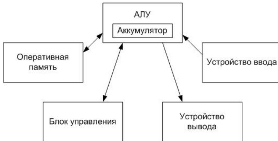
Рис. 1.1 Структурная схема машины фон Неймана
