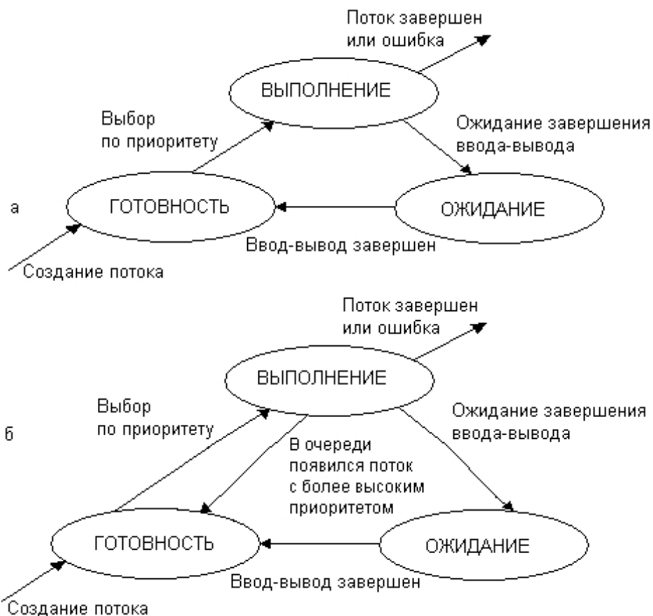
Рис. 4.6. Графы состояний потоков а – в системах с относительными приоритетами; б – в системах с абсолютными приоритетами
