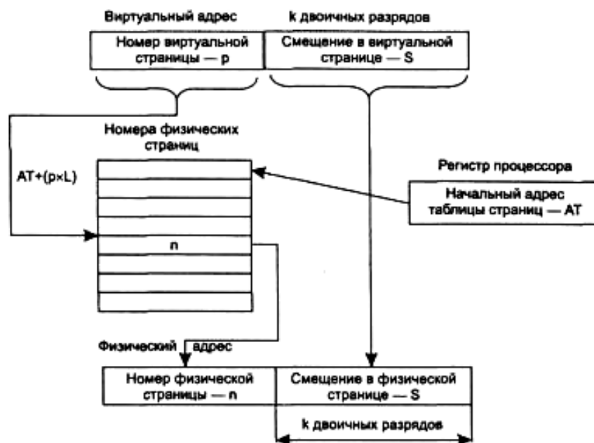
Рис. 5.11. Схема преобразования виртуального адреса в физический при страничной организации памяти
