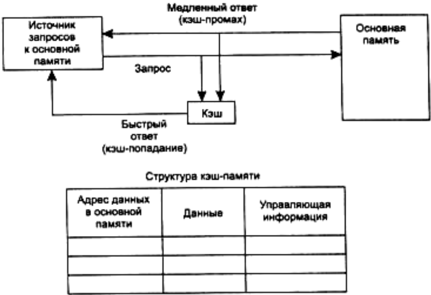
Рис. 5.21. Схема функционирования кэш-памяти
