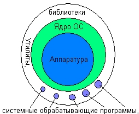
Рис. 3.5. Трёхслойная схема вычислительной системы
