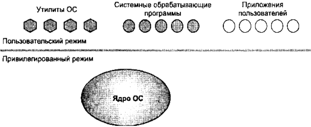
Рис. 3.3. Архитектура ОС с ядром в привилегированном режиме
