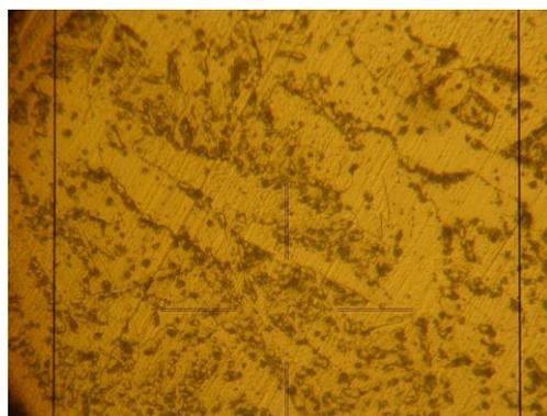
Рис. 4. Типичная микроструктура металла облицовочного слоя, ×400
