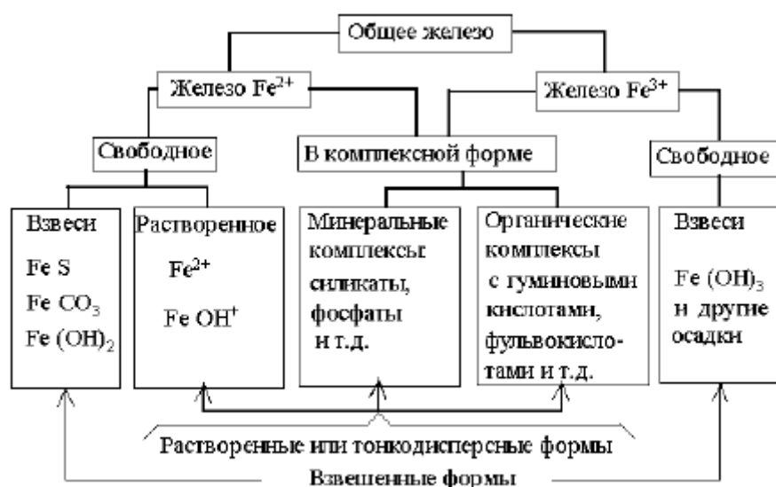
Рис. 1. Схема существования различных форм железа в воде
