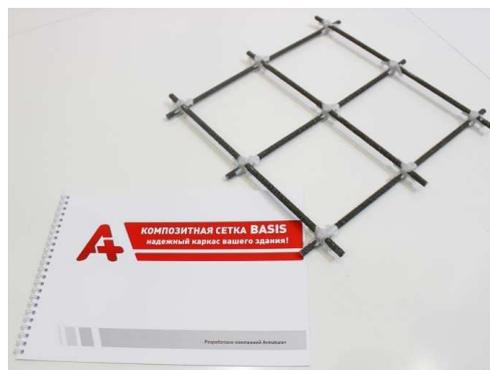
**Рисунок 3 – Композитная сетка, полученная на технологической линии**
