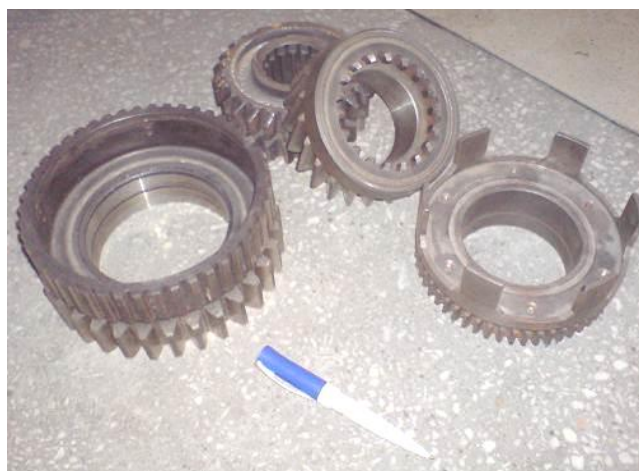
Рис. 2. Детали ОАО «Амкодор», изготовленные с помощью ЭЛС
