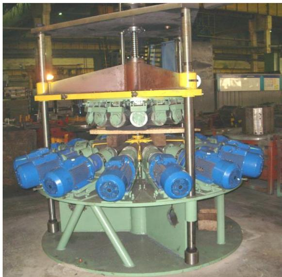
Рис. 2. Опытно-промышленная установка для динамической стабилизации фрикционных дисков
