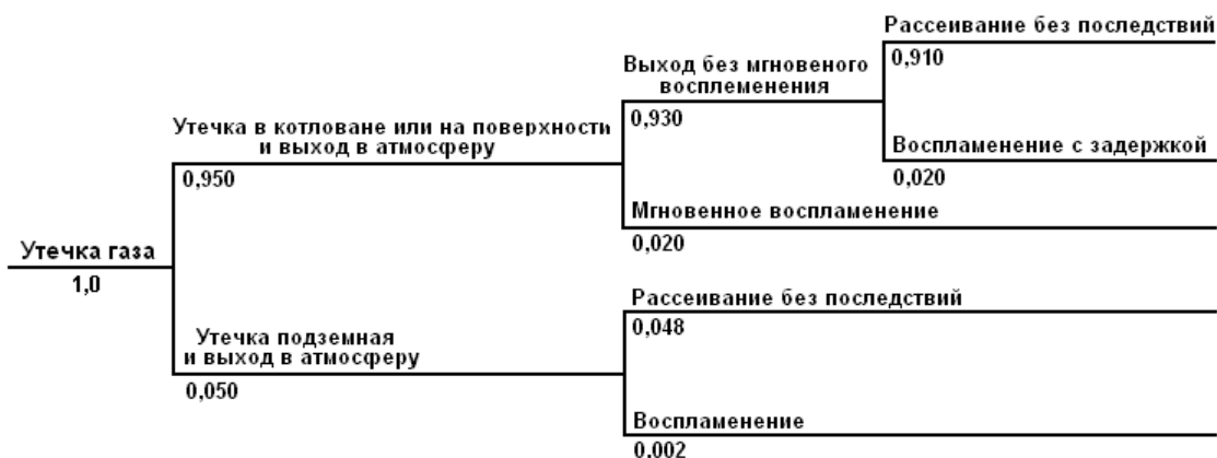
Рис. Дерево событий при аварии на межпоселковом полиэтиленовом газопроводе
