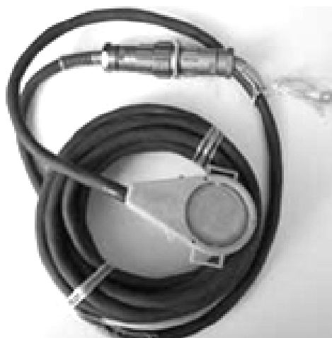
Рис. 1. Индикатор коррозионных процессов ИКП
