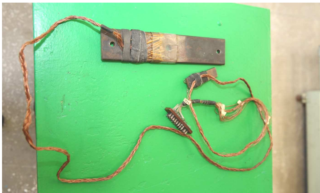
Рис. 3. Стальная полоса, ослабленная круглым отверстием, с тензодатчиками в сборе
