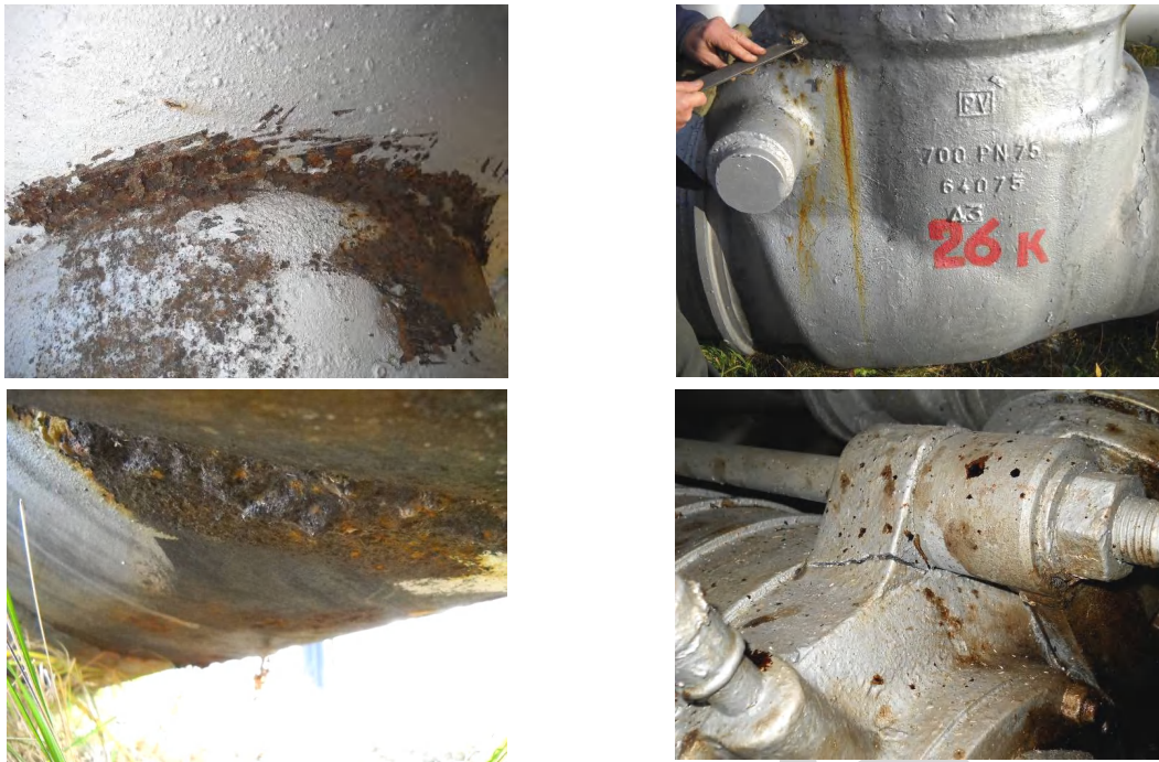
Рис. Типові дефекти технологічного устаткування нафтоперекачувальних станцій
