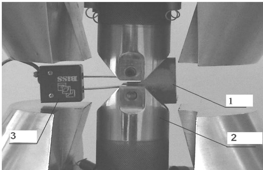
Рис. 3. Фото нагруженного образца на испытательной машине Vi-01-102:
