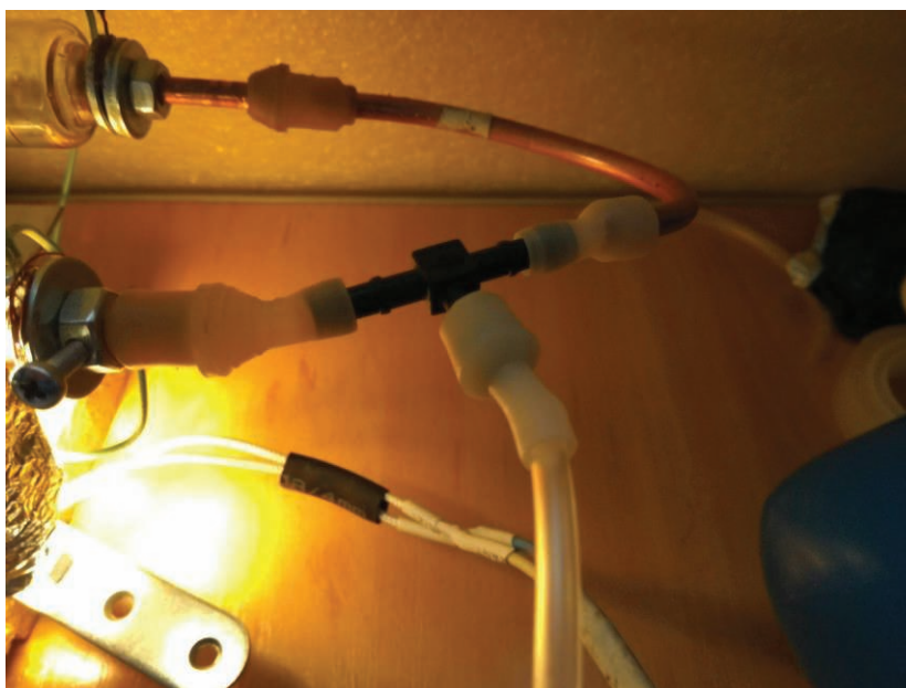
Рисунок 4.5. Заправка двигателя углекислотой.
