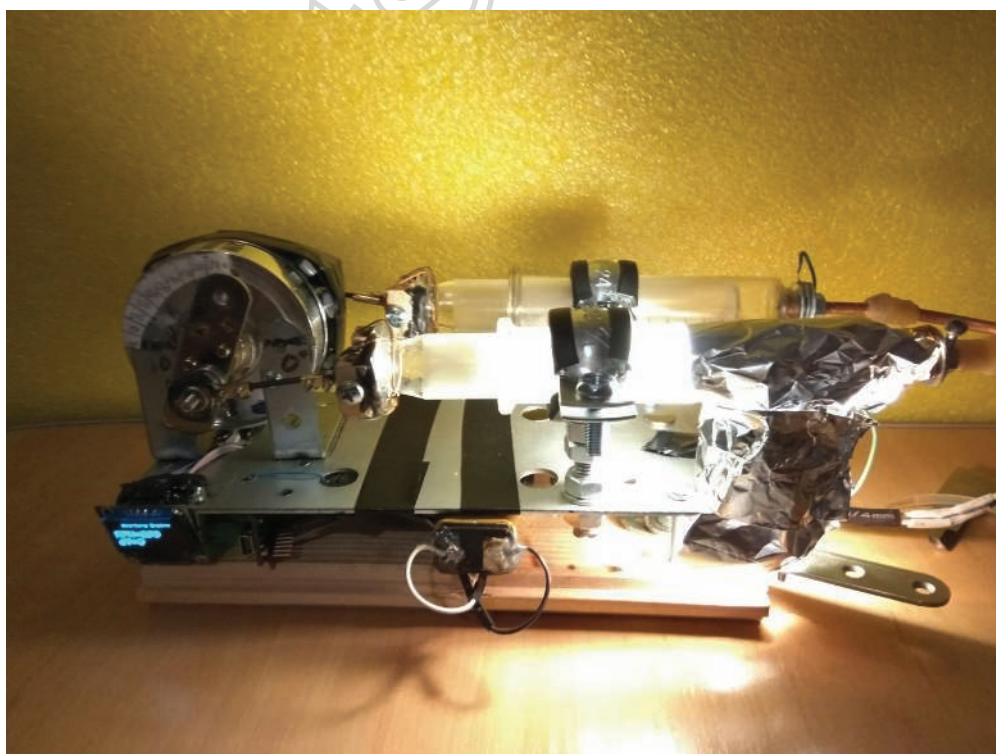
Рисунок 3.4. Работа двигателя от галогеновой лампы накаливания в качестве источника тепла.
