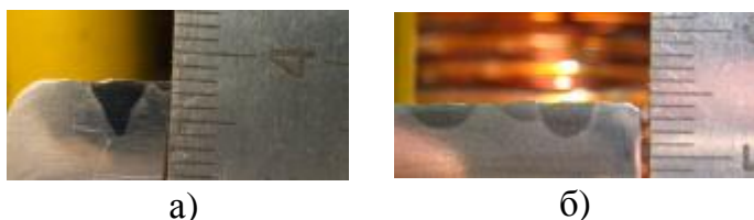
Рисунок 10 – Макрошлифы швов, полученных без ГДК (а) и при его наличии (б)
