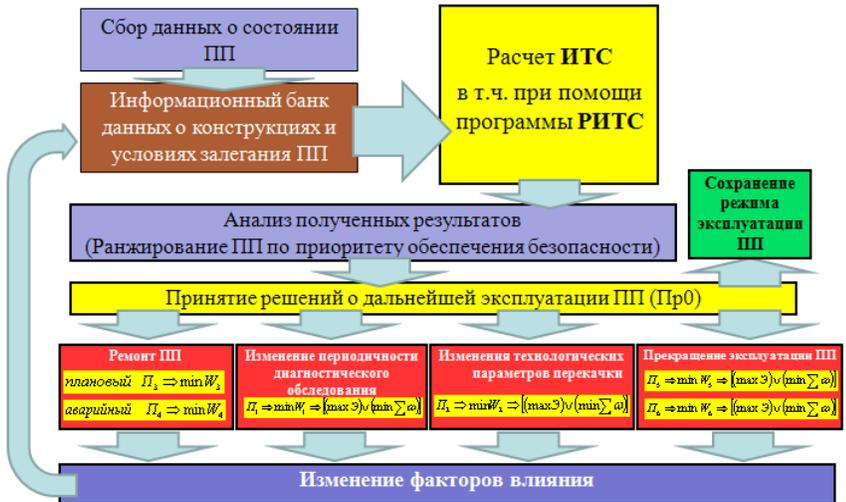
**Рисунок 11- Комплексная система мониторинга и прогнозирования технического состояния ПП**
