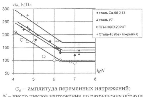
Рисунок 1 – Кривые усталости образцов с наплавленными покрытиями
