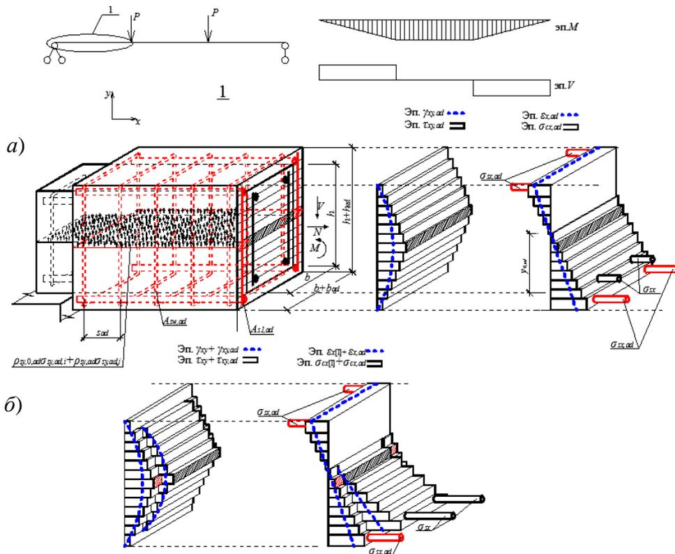
*a* – от приращения нагрузки после усиления; *б* – от полной нагрузки после усиления
