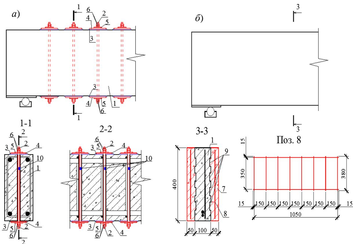
1 – усиляемый опытный образец; 2 – дополнительная поперечная арматура  $\text{Ø}12$  мм; 3 – слой гипсового раствора; 4 – стальная распределительная пластина; 5 – стальная пластина-шайба; 6 – гайка и контргайка; 7 – дополнительный бетон; 8 – плоский каркас с дополнительной поперечной арматурой; 9 – шпонки; 10 – линейные тензорезисторы
