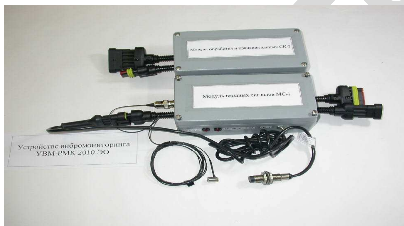
Рис. 1. Бортовая система вибромониторинга и диагностики РМК самосвала БелАЗ
