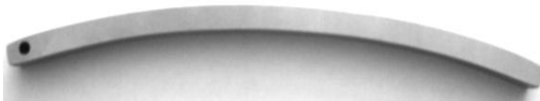
Рис. 1. Образец для испытаний на коррозионную стойкость
