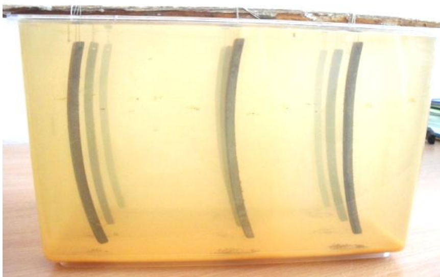
Рис. 2. Лабораторная установка для определения коррозионной стойкости (4-й день испытаний)
