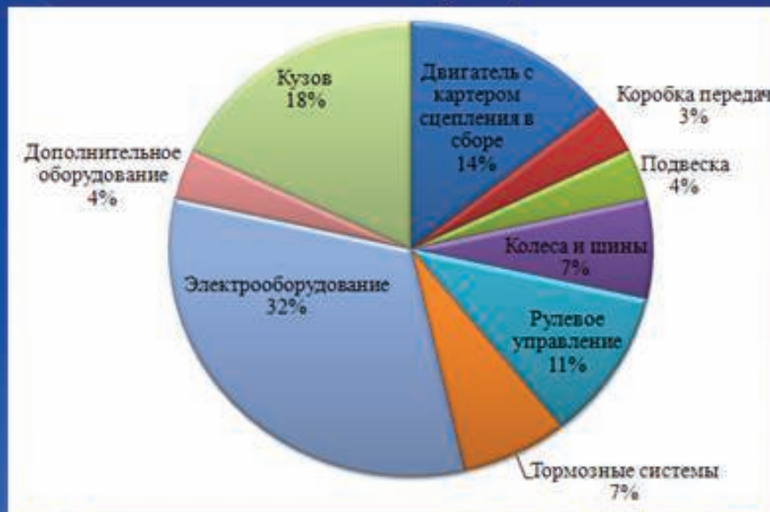
Диаграмма неисправностей автобуса МАЗ 103 в отношении узлов друг к другу
