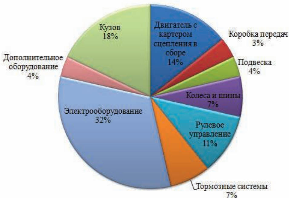
Рисунок 4.1 – Диаграмма неисправностей автобуса МАЗ 103 в отношении узлов друг к другу
