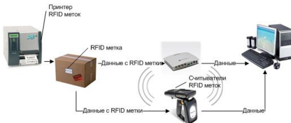
Рис. 12.3 Схема работы RFID-технологии
