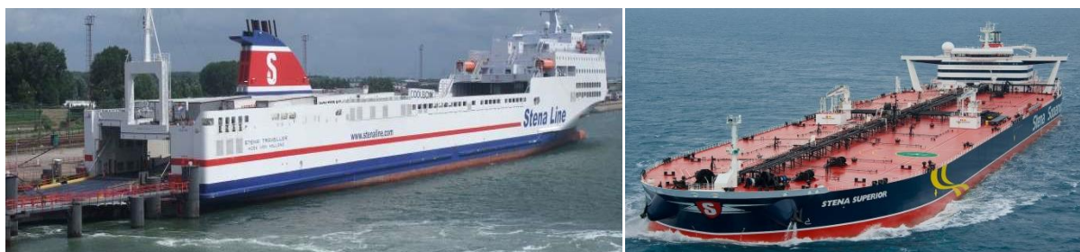
Рис. 7.1 Грузопассажирский ролкер и танкер
