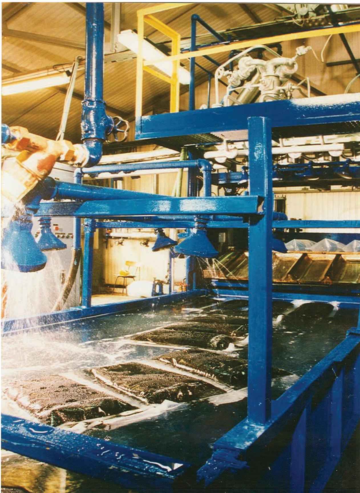
**Рисунок 3.4 – Промышленная установка упаковывания битума в полиэтиленовую пленку**
