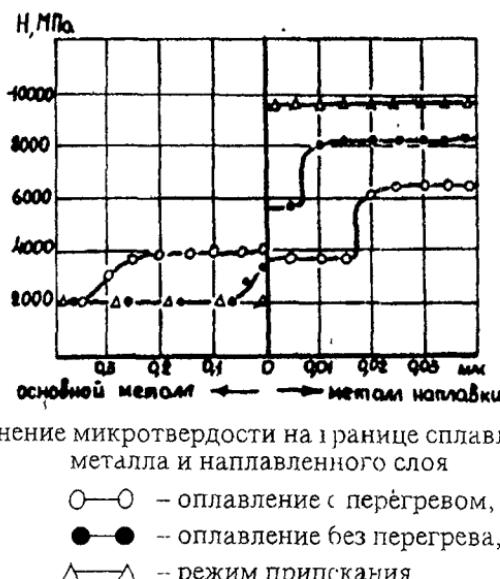
Рис. 4.5 Изменение микротвердости на границе сплавления основного металла и наплавленного слоя
