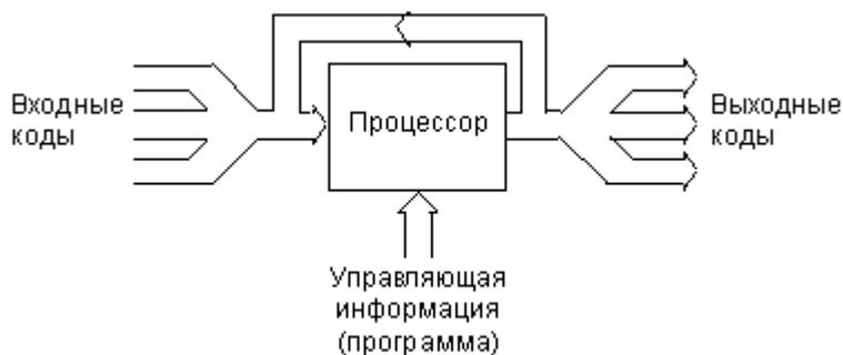
**Рис. 1.3.** Информационные потоки в микропроцессорной системе.
