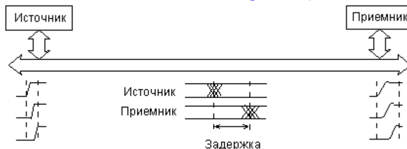
Рис. 2.14. Прохождение сигналов по шине.
