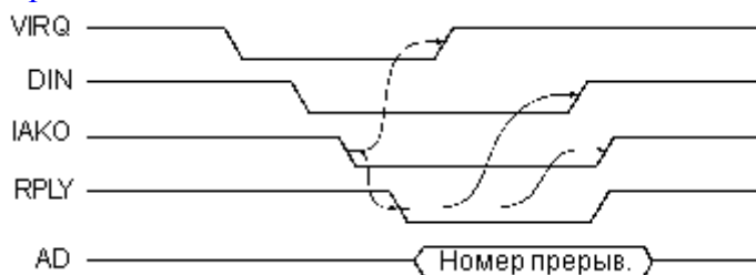
Рис. 2.9. Цикл запроса/предоставления векторного прерывания на магистрали Q-bus.
