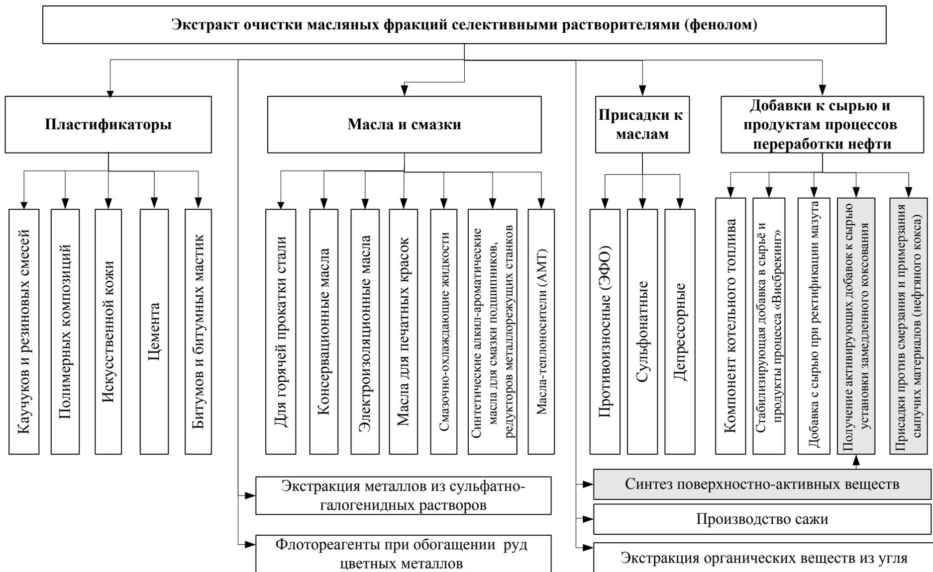
Рис. 4 – Направления переработки экстрактов, получаемых в процессе очистки масляных фракций селективными растворителями (перспективные направления исследований выделены серым)
