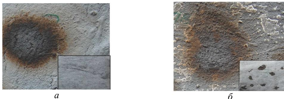
Рис. 1 – Фрагменты образцов широкоформатных углеродсодержащих экранов ЭМИ после воздействия открытого пламени: *а* – лицевая (оборотная) сторона экрана ЭМИ на основе углеродсодержащей смеси «активированный уголь- $\text{TiO}_2$ »; *б* – лицевая (оборотная) сторона экрана ЭМИ на основе углеродсодержащей смеси «технический углерод- $\text{TiO}_2$ »
