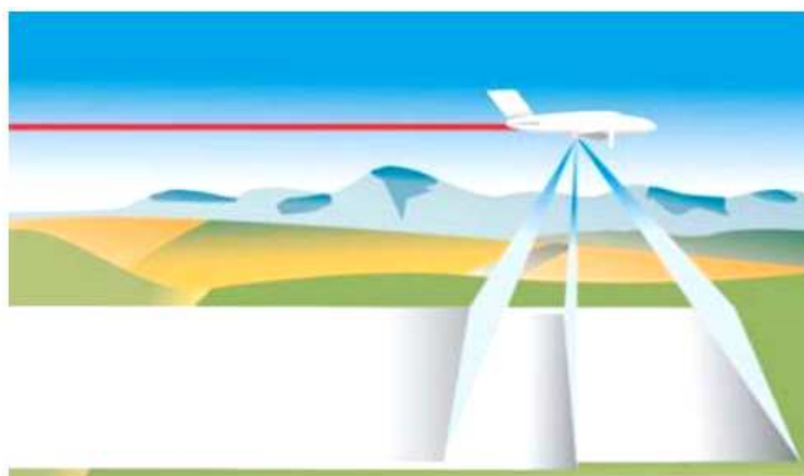
Рисунок 1. – Принцип работы линейного ПЗС-приемника
