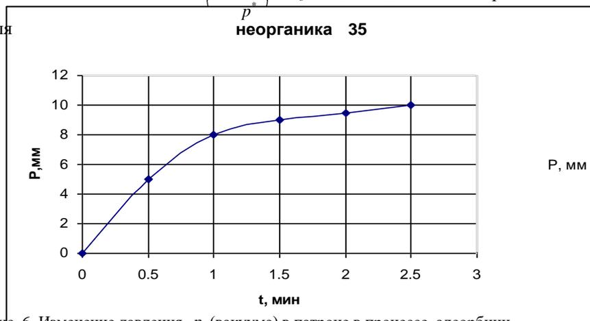
Рис. 6. Изменение давления  $p$  (вакуума) в патроне в процессе адсорбции
