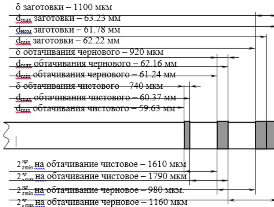
Рисунок 1 – Пример рисунка к расчету припусков
