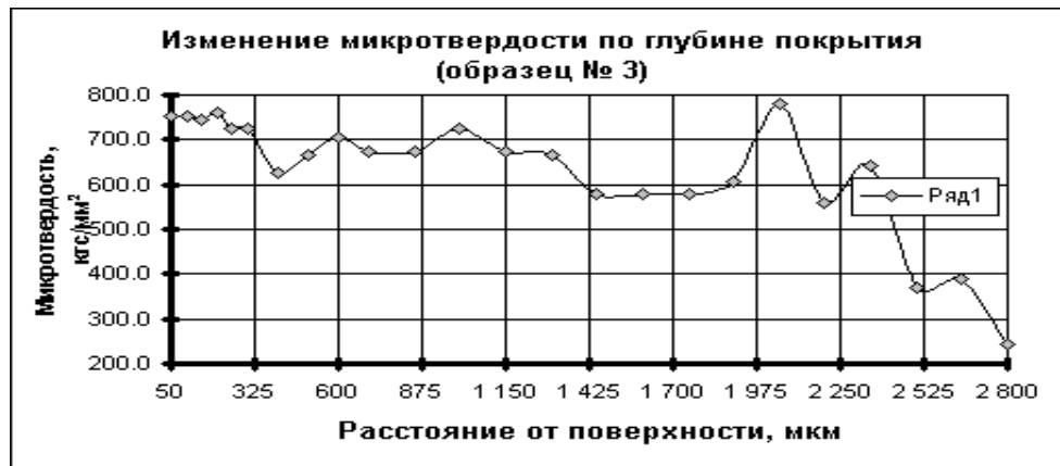
Рис. 2. Исследования микротвердости полученного покрытия
