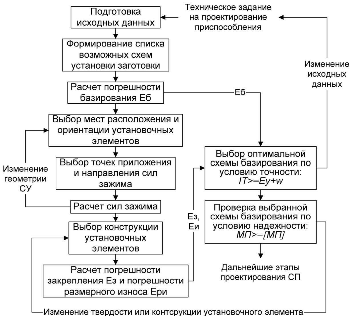
Рис. Схема алгоритма проектирования станочных приспособлений
