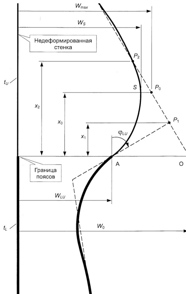
Рис. 4. Деформация стенки на границе поясов
