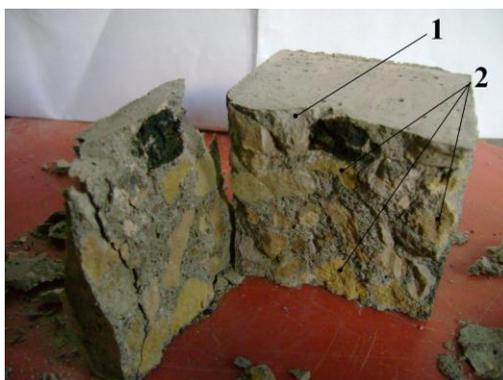
Рис. 5. Разрушение бетона на доломитовом щебне (состав Е 1)
