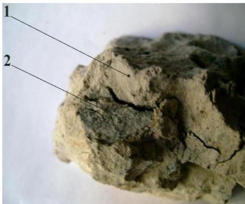
Рис. 3. Разрушение бетона на гранитном щебне (состав Е 1):
