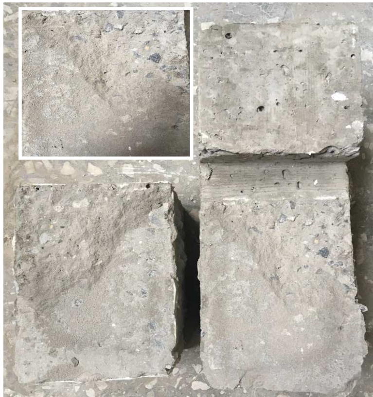
1 – образец группы Г-0; 2 - образец группы Г-1; 3 - образец группы Г-2; Рисунок 2.15 – Общий вид поверхностей разрушения
