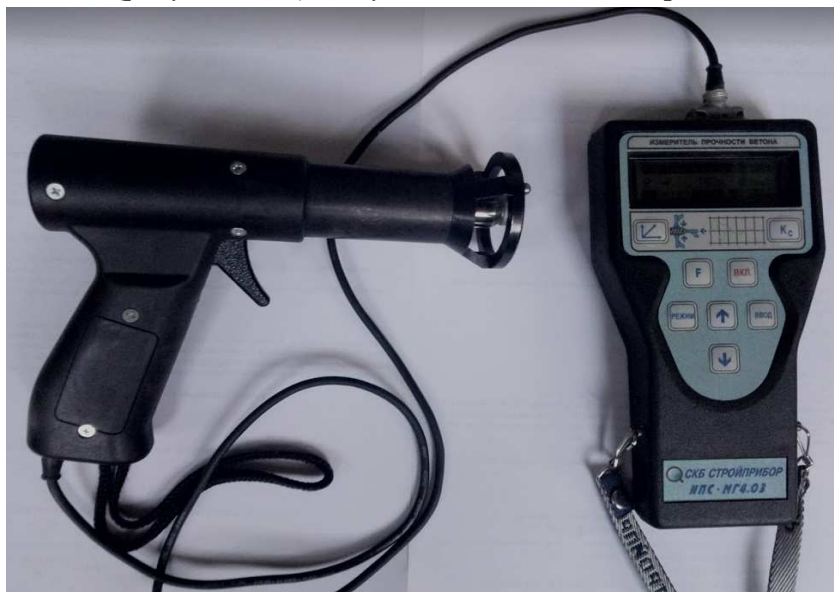
Рисунок 2.13 – Прибор для измерения прочности бетона методом ударного импульса ИПС-МГ4.03
