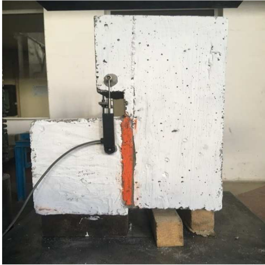
Рисунок 2.11 - Схема расстановки приборов, принятая в эксперименте
