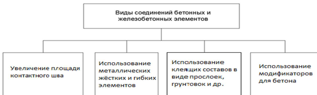
Рисунок 1.1 – Обеспечение прочности соединений бетонных железобетонных элементов
