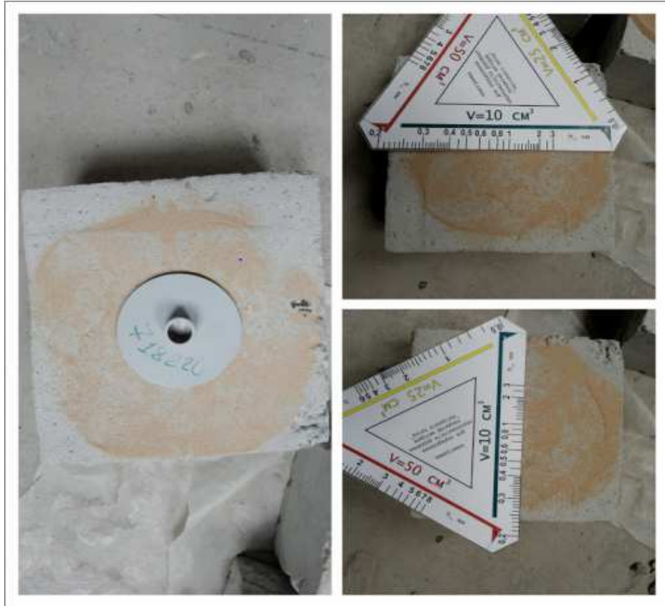
Рисунок 2.8 - Определение средней глубины шероховатости поверхности методом «песчаное пятно»
