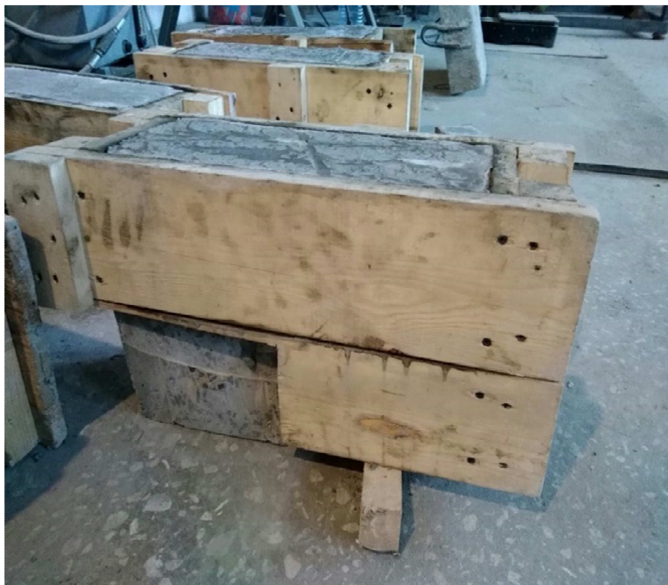
Рисунок 2.9 – Фото образца в опалубке
