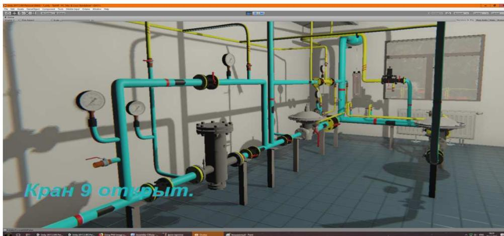
**Рисунок 5. – Визуализация заполнения труб газом**
