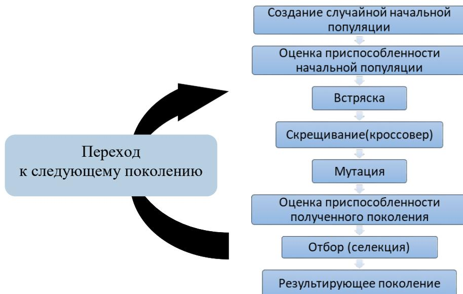
**Рисунок 1. – Схема генетического алгоритма для решения поставленной задачи**
