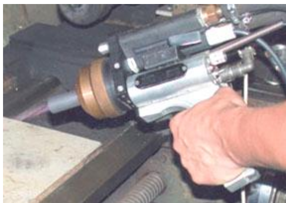
Рис. 5. Термораспылитель для нанесения покрытий распылением полимерных шнуров
