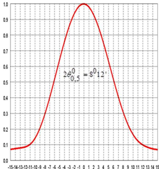
Рисунок 6. – Результат моделирования (АДН антенны в горизонтальной плоскости)
