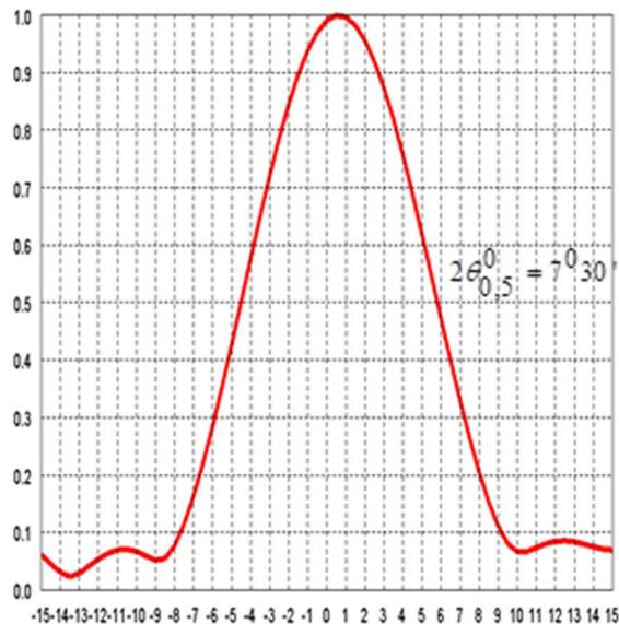
Рисунок 4. – Результат моделирования (АДН антенны в вертикальной плоскости)
