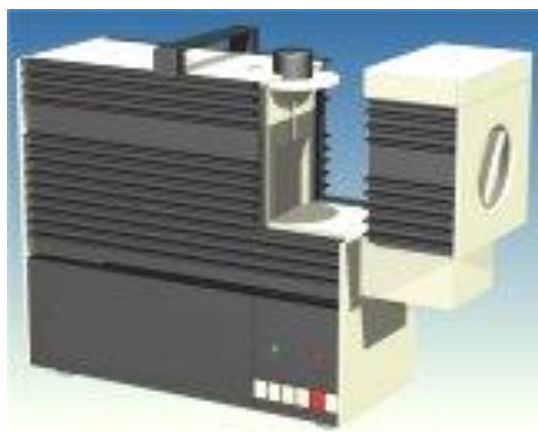
Рис. 2. Датчик компьютерной системы анализа фракционного состава нефтепродуктов 3-го поколения
