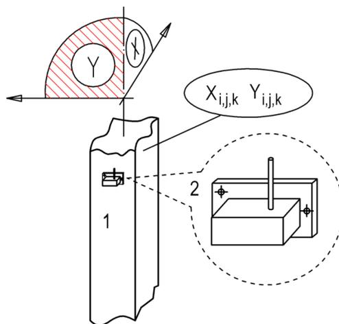
Рисунок 1. – Установка сенсора-инклинометра (2) на контролируемой колонне (1)
