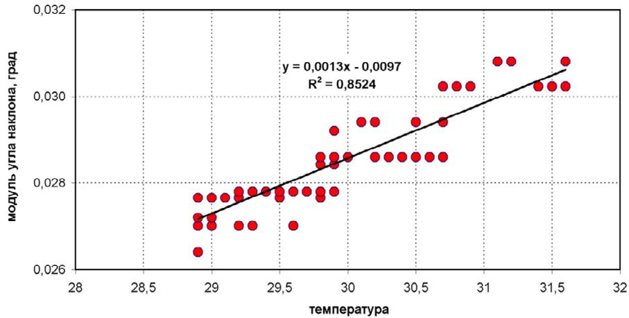
Рисунок 4. – Зависимость модуль угла наклона колонны ID-02 от температуры: коэффициент детерминации  $r^2 = 0,85$ ; коэффициент регрессии – 0,0013
