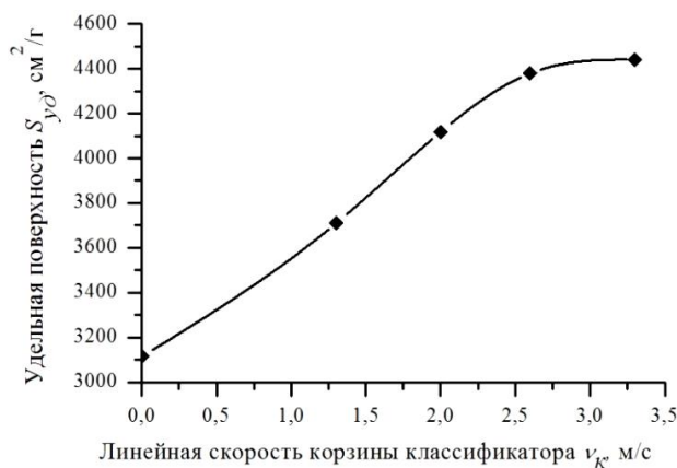
Рис. 1. Зависимость удельной поверхности материала S_{y\partial} от линейной скорости корзины классификатора v_k
