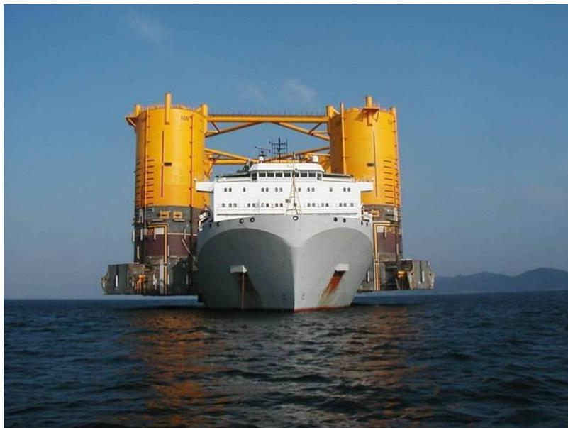
Рисунок 3.6 – Перевозка КТГ на морском судне
