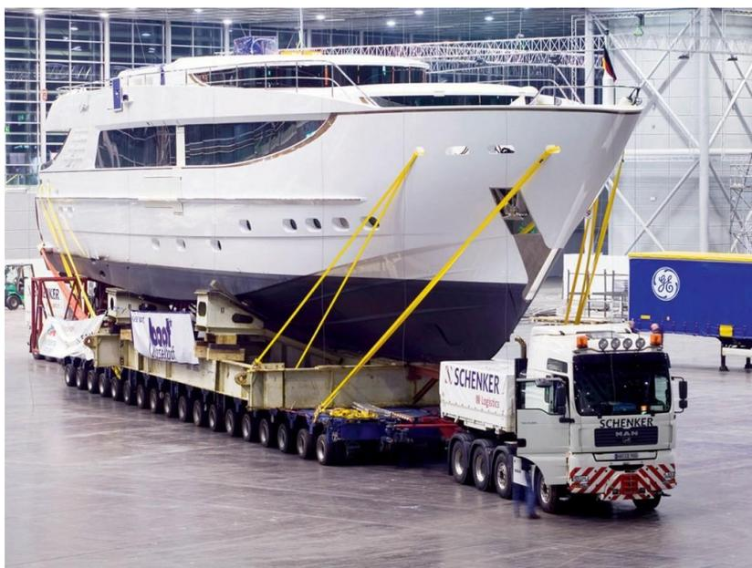
Рисунок 3.11 – Перевозка КТГ специализированным автотранспортным средством
