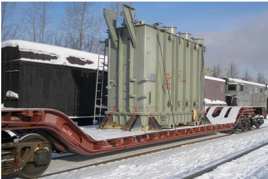
Рисунок 3.4 – Перевозка КТГ на специализированном железнодорожном транспорте
