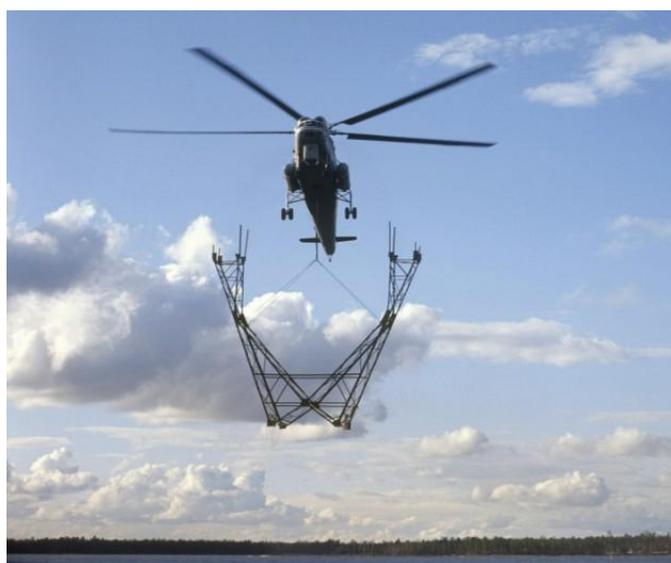
Рисунок 3.10 – Перевозка крупногабаритного груза весом 15 т вертолетом МИ-10
