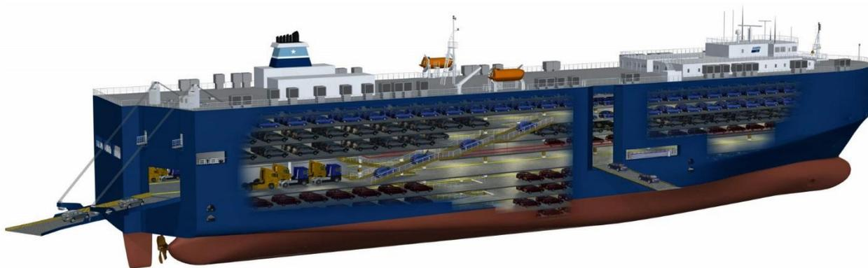
Рисунок 3.2 – Специализированное судно-автомобилевоз
