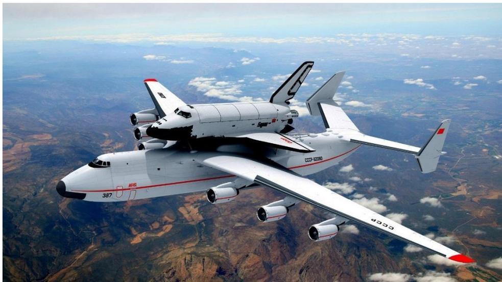
Рисунок 3.9 – Перевозка транспортным самолетом АН-225 «Мрия» груза снаружи фюзеляжа.
