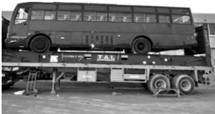
Рисунок 3.15 – Транспортировка автобуса, закрепленного на флете,
