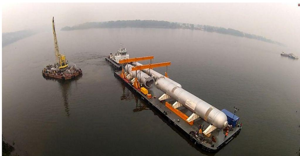
Рисунок 3.7 – Перевозка реактора для Ачинского НПЗ речным транспортом
