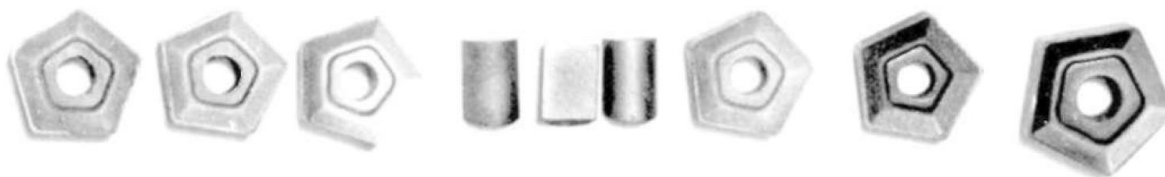
Внешний вид твердосплавных пластин после химико-термической обработки
