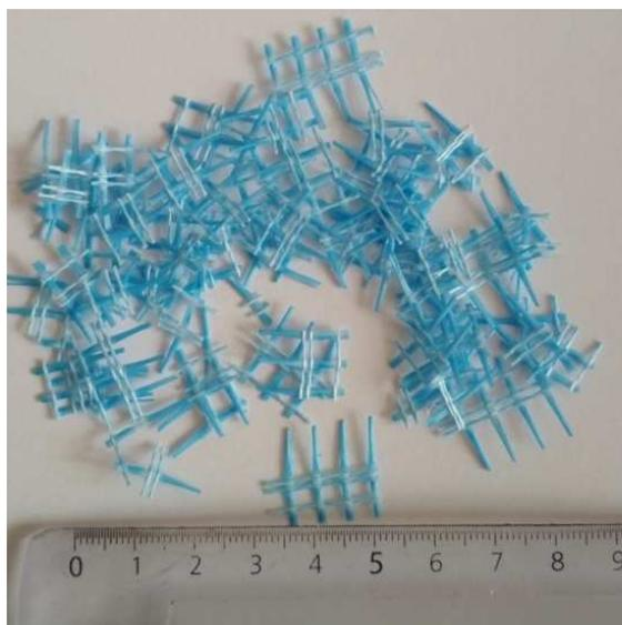
Рисунок 1. – Отходы производства щелочестойкой стеклосетки ССШ-160(100)-1800/1800
